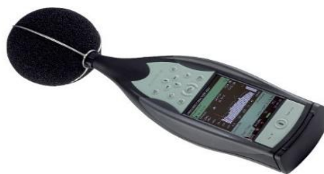
1 pav. „Brüel & Kjær“ 2250 analizatorius su UA-1650 apsauga nuo vėjo Fig.1 „Brüel & Kjær“ 2250 analyser with UA-1650 protection from wind
