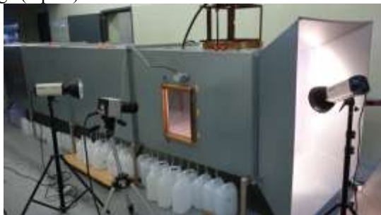
2 pav. Išpurkštų tirpalų lašelių greičio nustatymo įranga Fig. 2. The device for investigation of spray droplets speed
