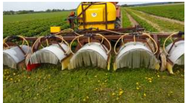
1 pav. Pakabinamo hidraulinio lauko purkštuko su specialia įranga braškių lysvėms apipurkšti bendras vaizdas
