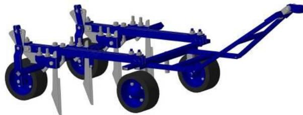
**Рис. 3.** 3-D модель устройства для регистрации электропроводных свойств почвы.
