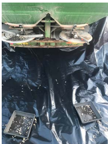
1 pav. Dėžučių išdėstymas po traktoriaus ratus, kai disko mentė 29 cm
