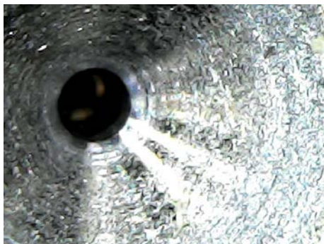
3 pav. Valdymo vožtuvo lizdo paviršius po 30000 km eksploatacijos
