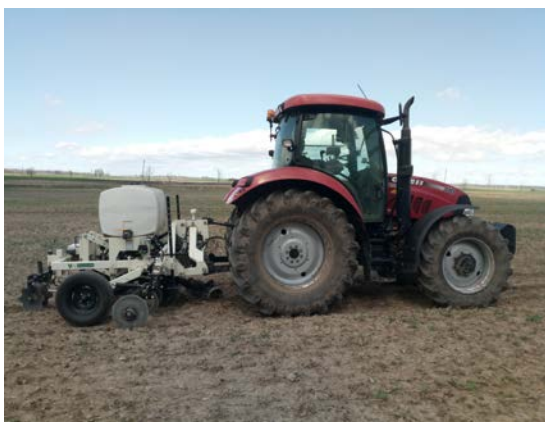
1 pav. Mobilus dirvožemio analizės įrenginys Veris 3150 MSP
