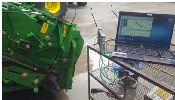
1 pav. 1 – akselerometras 4370; 2 – duomenų kaupiklis 3580 Bruel&Kjaer įranga; 3 – kompiuteris su programine įranga (pulse)
