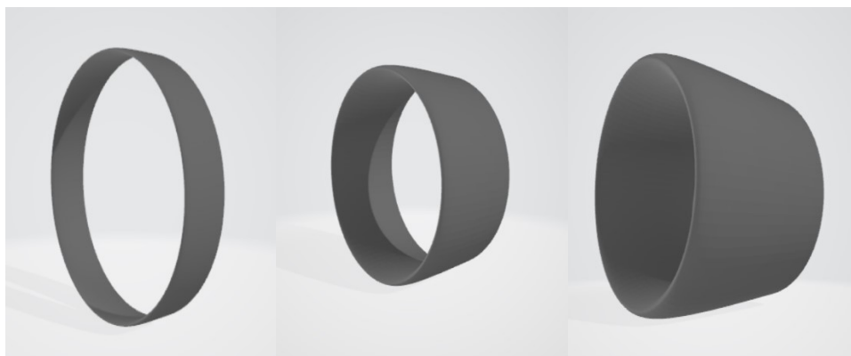
2 pav. Difuzoriai 1060 mm skersmens ir atitinkamai 200, 500 ir 1000 mm ilgio
