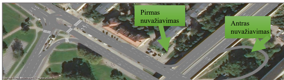
4 pav. Nr. 4 modelis – turbožiedinė sankryža su nuvažiavimais nuo vakarinio aplinkkelio (bendras vaizdas)
