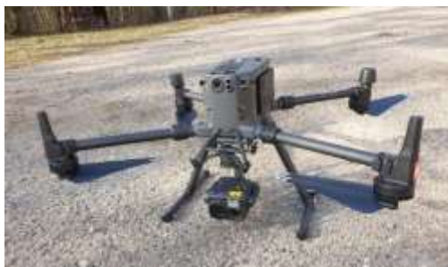
1 pav. Bepilotis orlaivis Matrice 300 RTK su Zenmose H20 T kamera ir leidimas pilotuoti bepiločius orlaivius A1/A3 atviroje kategorijoje
