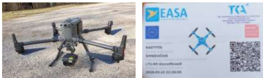
1 pav. Bepilotis orlaivis Matrice 300 RTK su Zenmuse H20 T kamera ir leidimas pilotuoti bepiločius orlaivius A1/A3 atviroje kategorijoje
