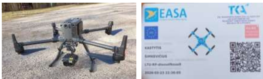
1 pav. Bepilotis orlaivis Matrice 300 RTK su Zenmose H20 T kamera ir leidimas pilotuoti bepiločius orlaivius A1/A3 atviroje kategorijoje.
