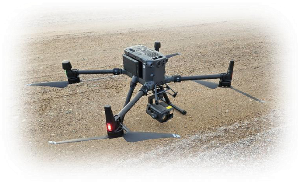
1 pav. Bepilotis orlaivis Matrice 300 RTK su hibridine kamera Zenmuse H20t
